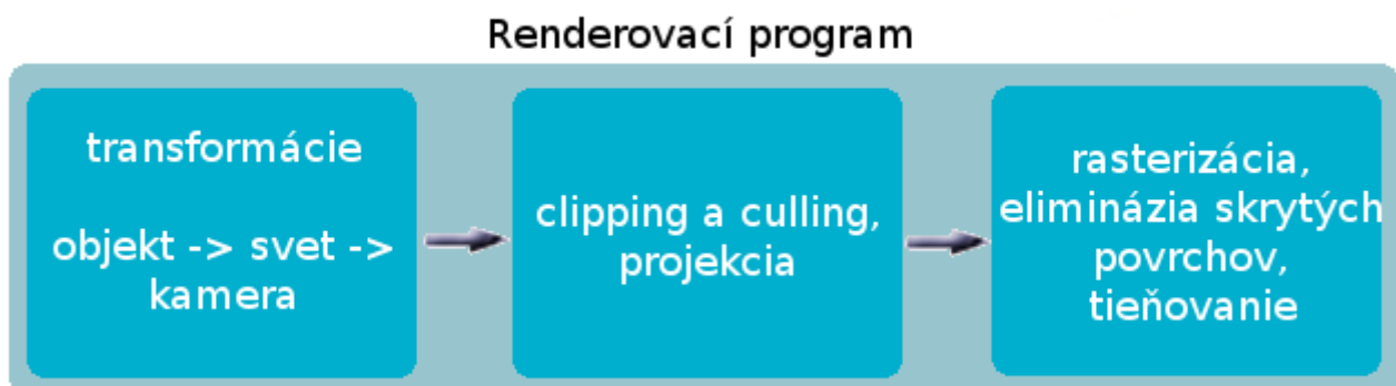
Obrázok 2.1 – schéma renderovacej pipeline
